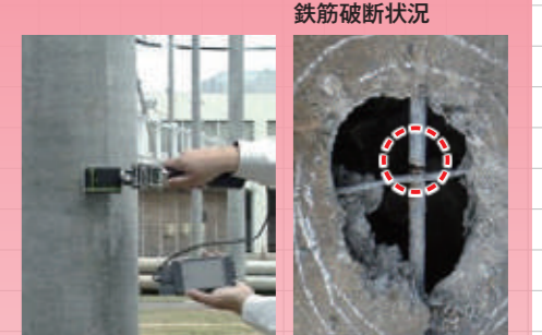
らせん筋の裏側での破断も診断可能
